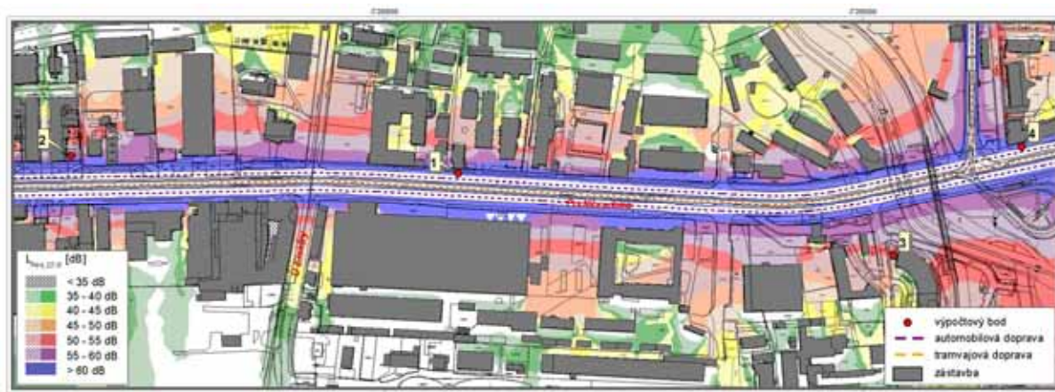
Obr. 25: L_{Aeq} [22 až 6 hod], stav bez realizace záměru, výhled ÚP, izofony ve výšce 3 m nad terénem
