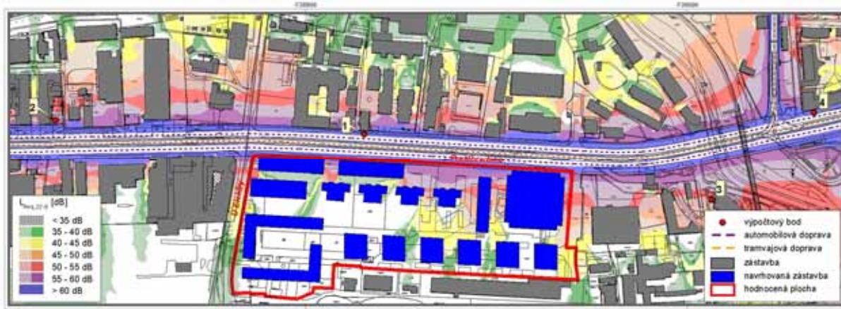
Obr. 23: L_{Aeq} [22 až 6 hod], stav po realizaci záměru, rok 2018, izofony ve výšce 3 m nad terénem
