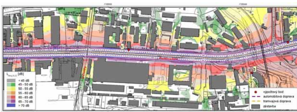
Obr. 20: L_{Aeq} [6 až 22 hod], stav bez realizace záměru, rok 2018, izofony ve výšce 3 m nad terénem
