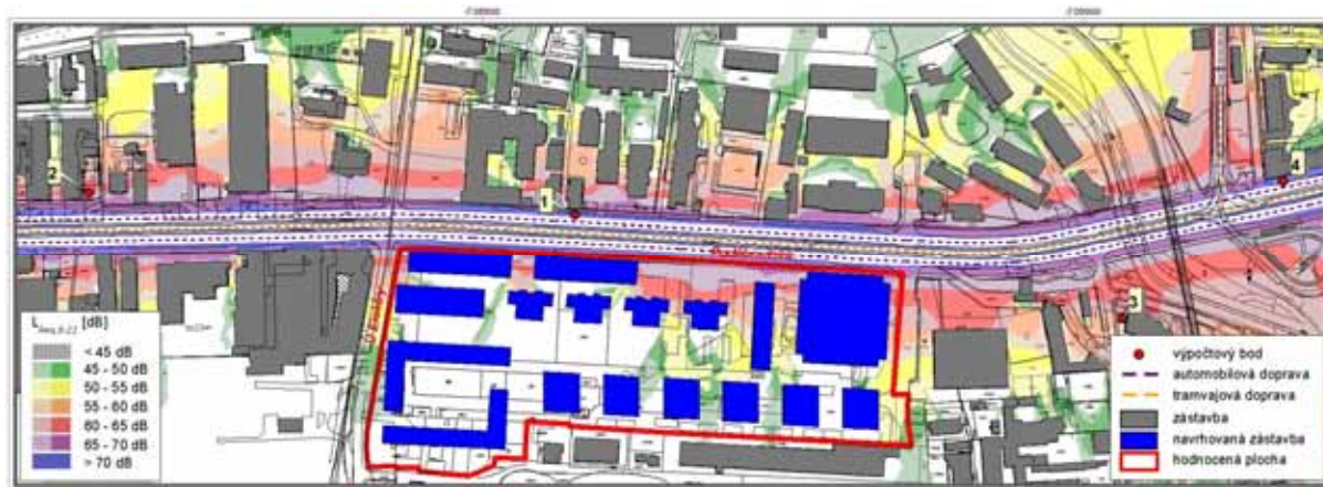
Obr. 26: L_{Aeq} [6 až 22 hod], stav po realizaci záměru, výhled ÚP, izofony ve výšce 3 m nad terénem
