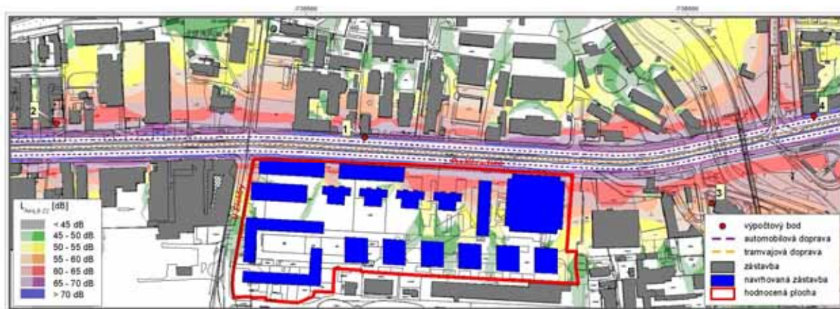
Obr. 22: L_{Aeq} [6 až 22 hod], stav po realizaci záměru, rok 2018, izofony ve výšce 3 m nad terénem
