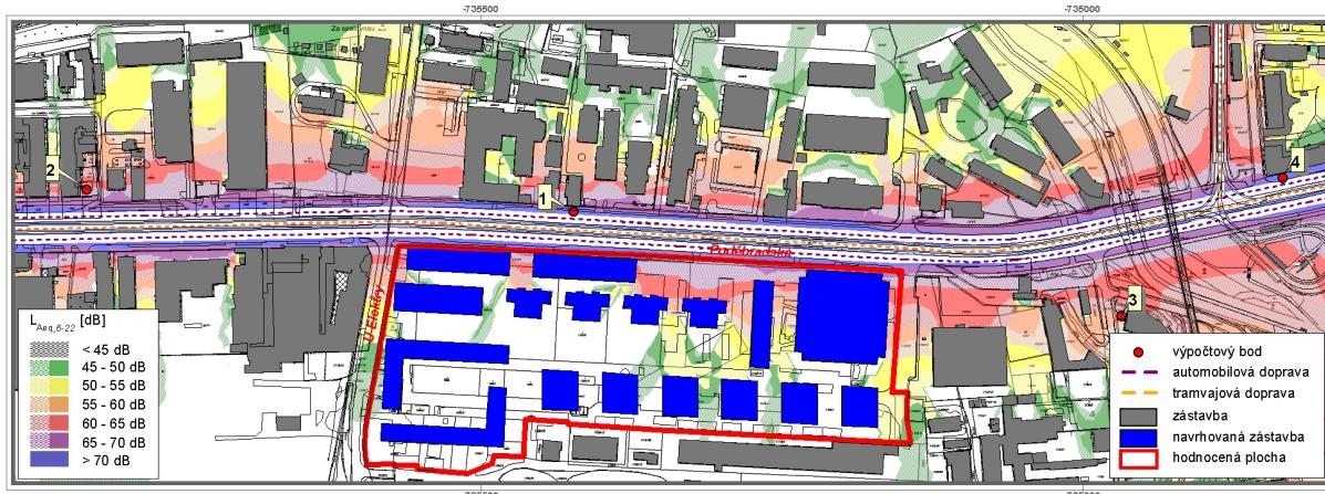
Obr. 26:  $L_{Aeq}$  [6 až 22 hod], stav po realizaci záměru, výhled ÚP, izofony ve výšce 3 m nad terénem
