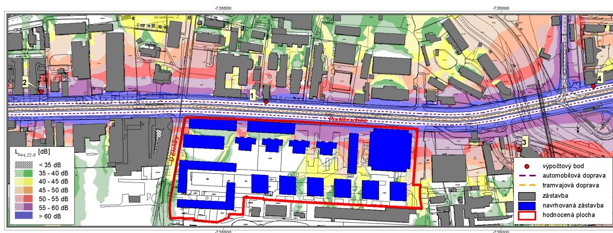
Obr. 27:  $L_{Aeq}$  [22 až 6 hod], stav po realizaci záměru, výhled ÚP, izofony ve výšce 3 m nad terénem
