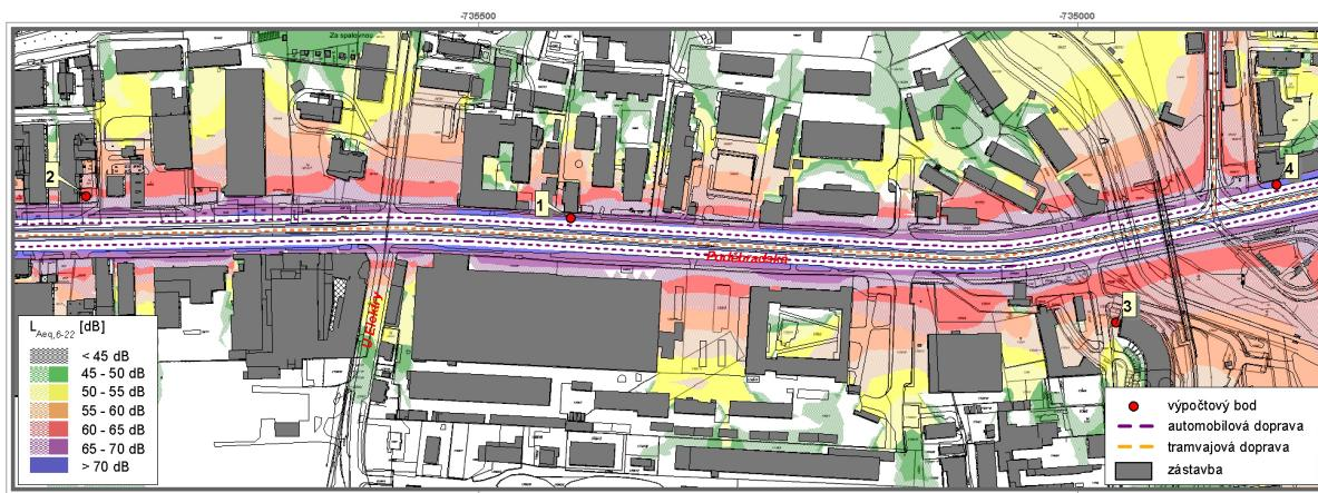
Obr. 20:  $L_{Aeq}$  [6 až 22 hod], stav bez realizace záměru, rok 2018, izofony ve výšce 3 m nad terénem
