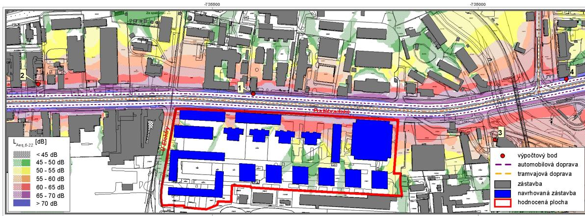
Obr. 22:  $L_{Aeq}$  [6 až 22 hod], stav po realizaci záměru, rok 2018, izofony ve výšce 3 m nad terénem
