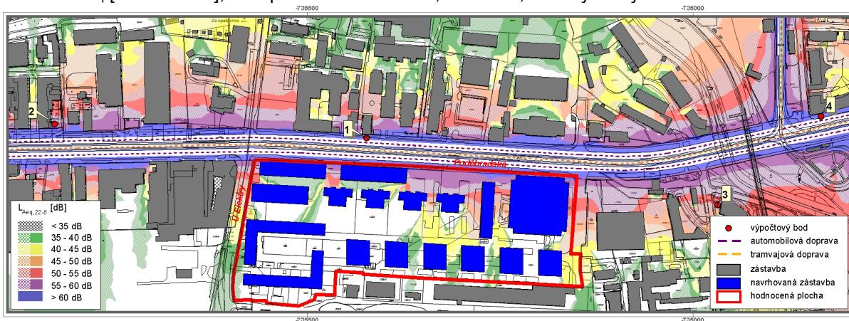
Obr. 23:  $L_{Aeq}$  [22 až 6 hod], stav po realizaci záměru, rok 2018, izofony ve výšce 3 m nad terénem
