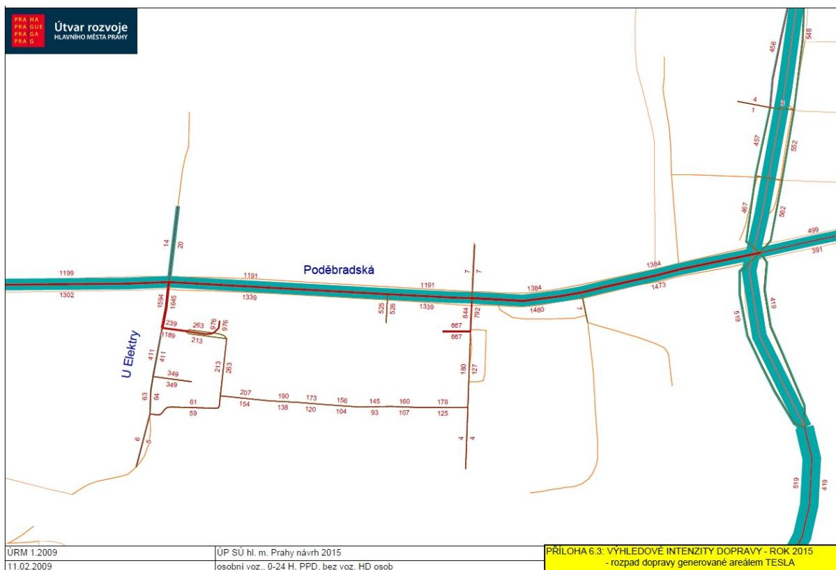
Obr. 29. Rozpad dopravy na okolní komunikace<sup>3</sup>
