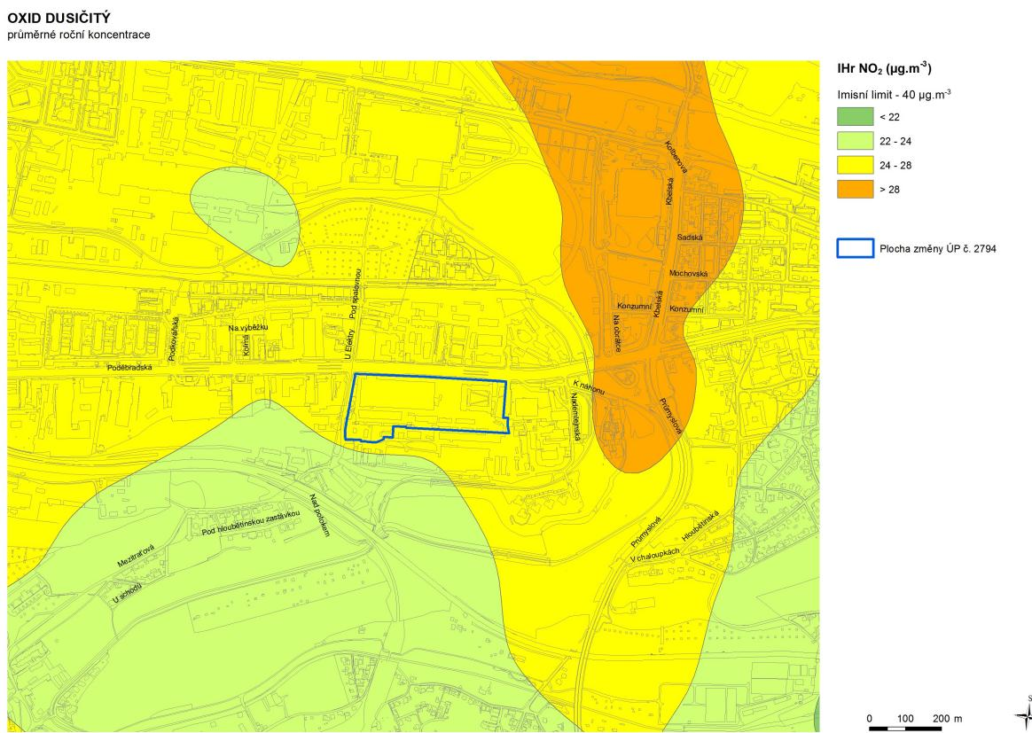
Obr. 16: Průměrné roční koncentrace oxidu dusičitého ve výhledu
