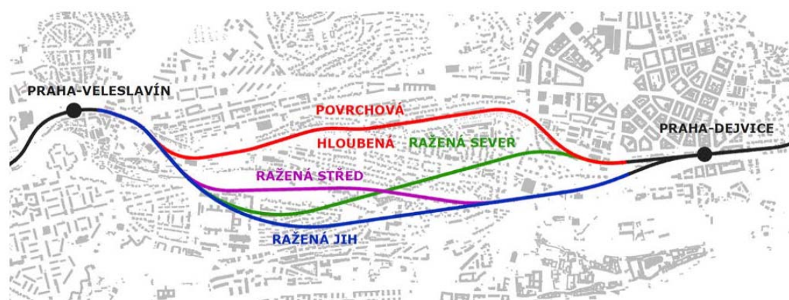
Obrázek 1: Schéma variant posuzovaných studií. (Zdroj: studie „Porovnání variant tunelového řešení v úseku Praha-Dejvice – Praha-Veleslavín“)
