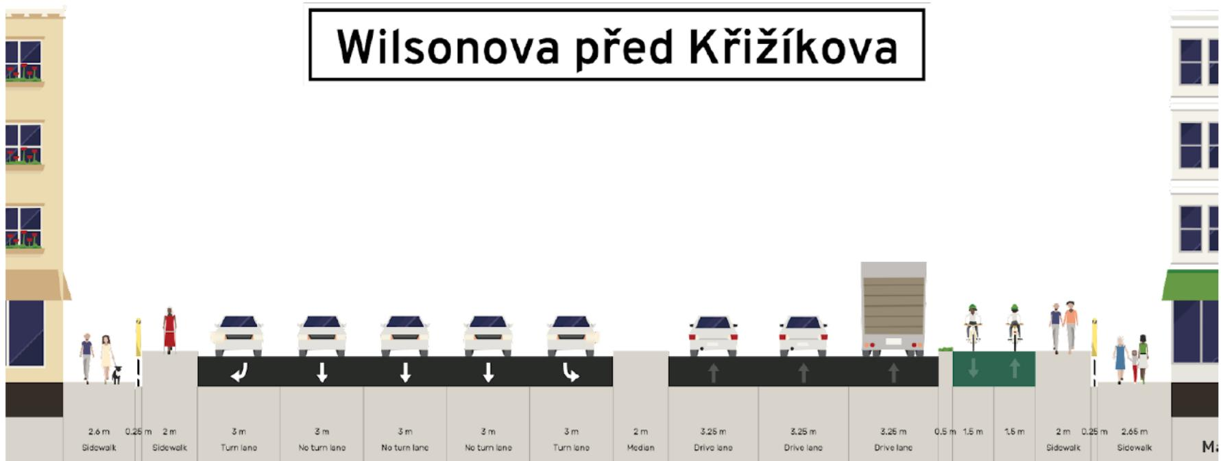
V případě jiné konfigurace (například 2 JP + 4 řadící JP) nabízí 40metrový profil důstojné podmínky pro řešení pěší i cyklistické dopravy i při zachování více než čtyřmetrového odstupu přemostění od fasád, vytváří prostor pro zřízení stromořadí, apod.
